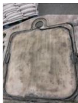
REPARACION DE TAPA DE BOMBA CENTRIFUGA MOLINO SAG MNA. ESPERANZA
